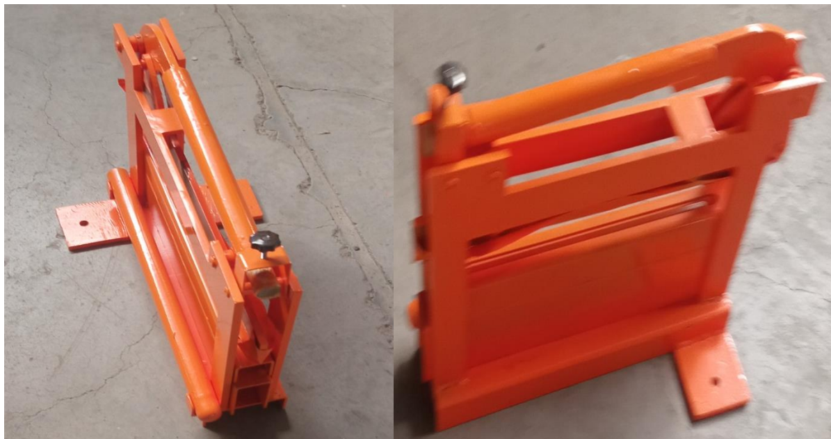
شکل ۲۷- تجهیز جهت برش بلوک های پرین
