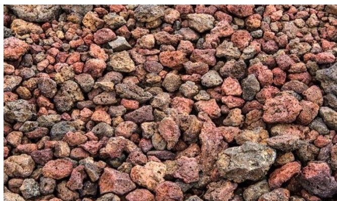
شکل ۱۰۷- پوکه معدنی جهت تولید بلوک لیکا
