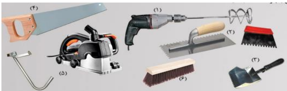
شکل ۹۹ - تجهیزات لازم جهت اجرای دیوار با بلوک پرین: ۱- همزن چسب بلوک پرین، ۲- ماله یا کاردک دندانه دار، ۳- بیلچه فلزی شیاردار، ۴- اره دستی یا برقی، ۵- شیارزن دستی یا برقی، ۶- برس
