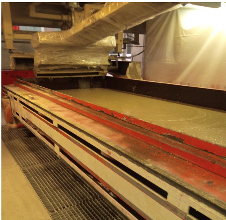
شکل ۷- مرحله قالب گیری (تزریق دوغاب به قالب)
