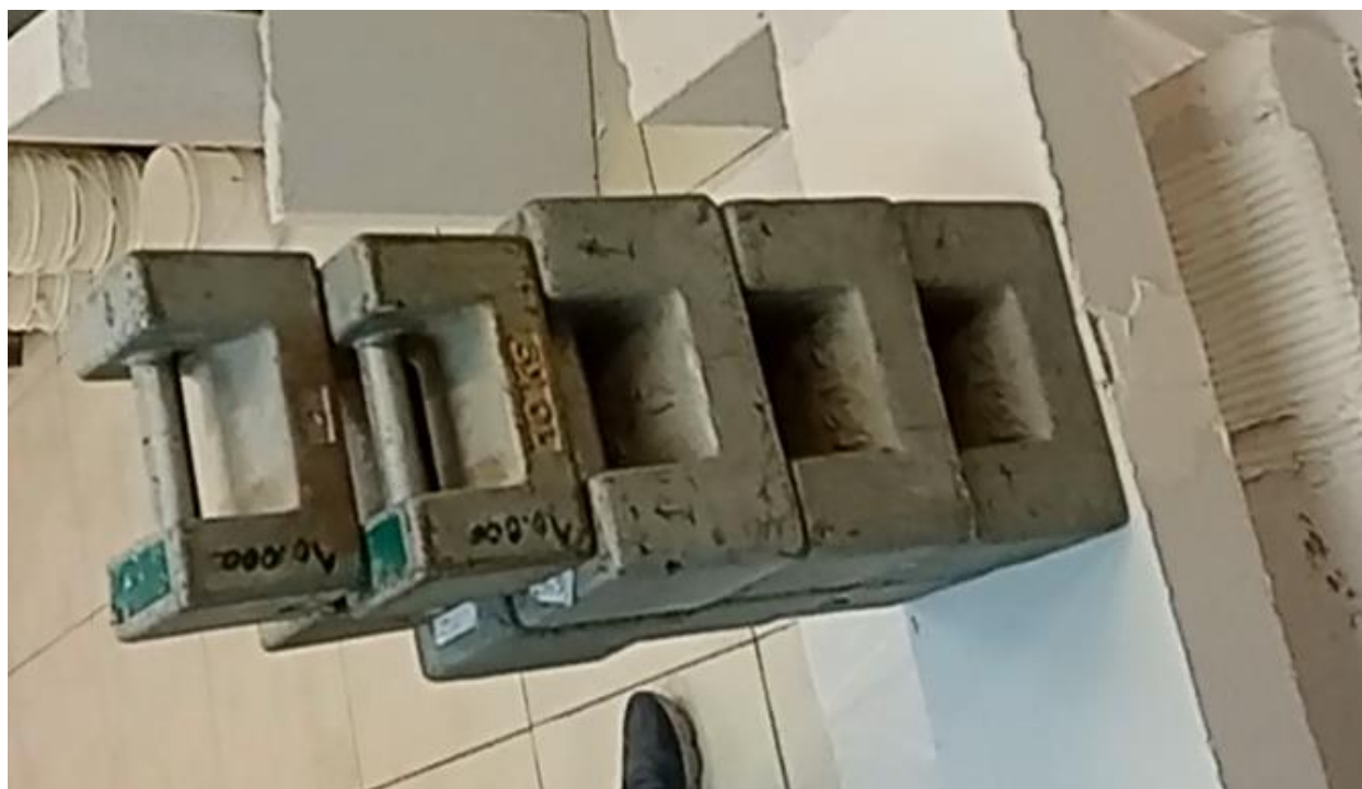
شکل ۱۶- میزان مقاومت بلوک های متصل پرین شامل لایه مش
