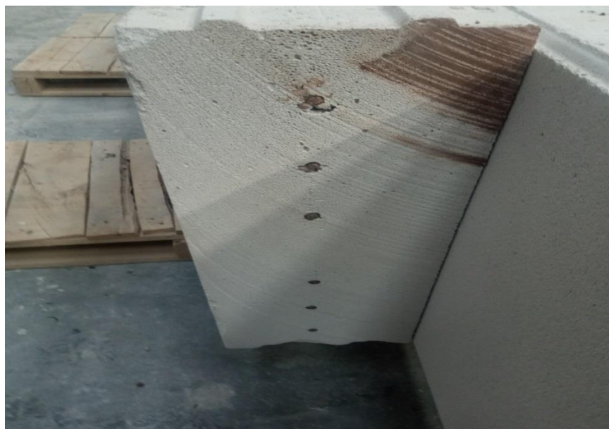
شکل ۲۸ - نمونه بلوک مسلح پرین
