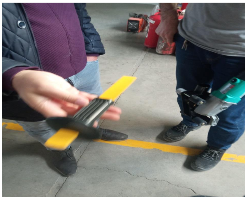
شکل ۲۶- تجهیز جهت کندن شیپار داخل بلوک پرین
