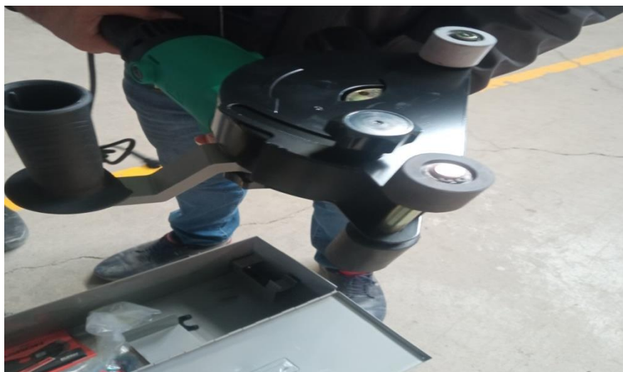
شکل ۲۴- دستگاه شیار زن جهت اجرای تاسیسات بر روی بلوک های پرین
